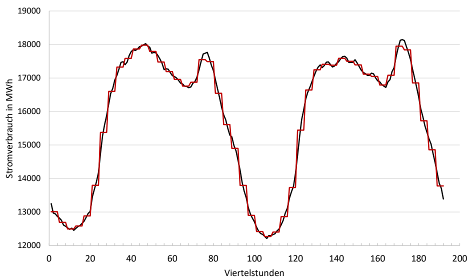
Abb. 2: Vergleich unterschiedlicher Auflösungen bei der Messung des Stromverbrauchs am 5. und 6. März 2019, schwarz die 15-min-Auflösung, rot die 60-min-Auflösung.
